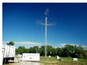
Antenne large bande pour tests électromagnétiques
